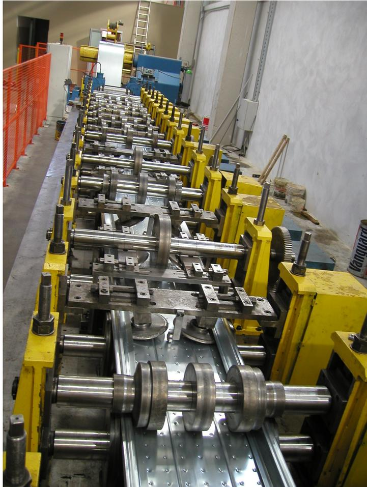
Il corpo principale della profilatrice ha una dimensione di 15 metri circa, per circa 2200 di larghezza, l'aspo svolgitore con culla occuperà uno spazio di circa 5000 x 2000 mm, il quadro elettrico 1000 x 500 mm - h2000, riduttore e centralina occupano 2000 x 2000 mm.
